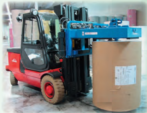
Hydraulický nosný trn PT20-H Hydraulic supporting rod PT20-H
