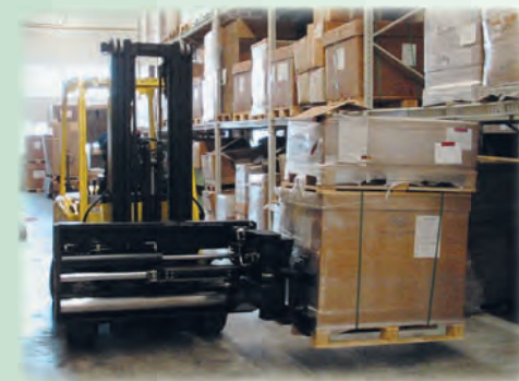
Zakládací zařízení THU pro zakládání břemen do regálů THU equipment for loads loading into shelves
