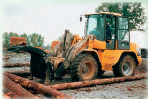
Přidržovač dřeva PD02 Wood holder PD02 (round wood)
