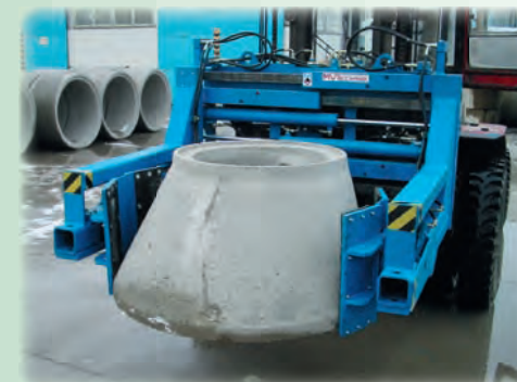
GA25 svěrací zařízení s rameny na betonové prvky a otáčením 90° Clamping device GA25 with arms for concrete elements and with 90° rotation
