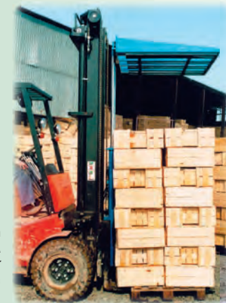
Přidržovač břemen s protitlakem PP04-A Loads holder with back pressure PP04-A
