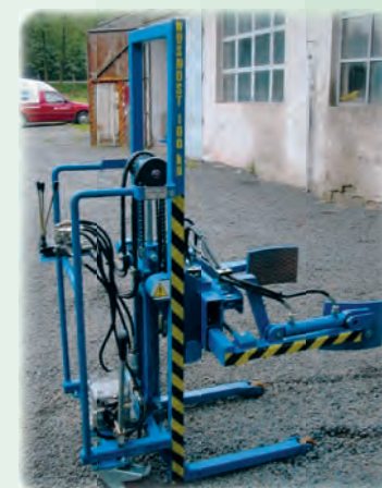
RPC10-R/H Vozík s otočí na válcová břemena RPC10-R/H Truck with rotating clamps for cylindrical loads
