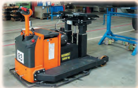
Tahač v úpravě na pojezd návěsů Towing vehicle designed for semitrailers travel
