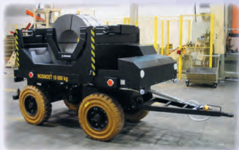
Transportní vozík TV100S pro manipulaci se svitky plechu Transport truck TV100S for metal sheet scrolls handling
