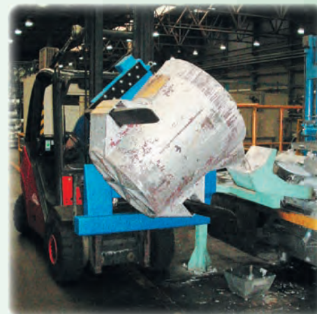
Otáčecí zařízení pro kelímky RA15H Revolving device RA15H for crucibles
