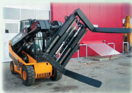
Stavitelné svěrací vidlice GVO s otáčením 360° Adjustable clamping fork GVO with 360° rotation
