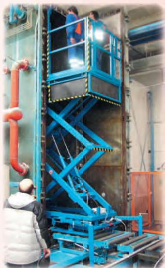
Zdvihací plošina LD 05-2400 určená pro manipulaci při čištění vypěňovacích forem pro polystyren Lifting platform LD05-2400 for handling at cleaning of foaming forms for polystyrene
