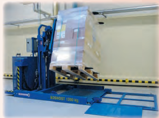
Stacionární manipulátor MPR1 na výměnu palet Stationary manipulator MPR1 for pallets replacement
