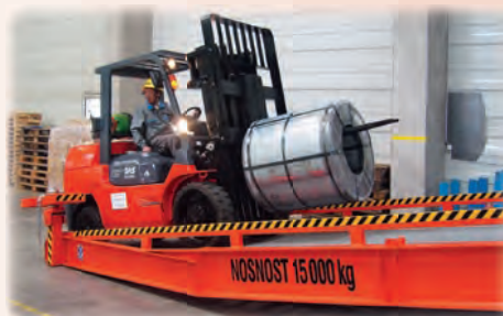
Nájezdová plošina pro komfortní nakládání a vykládání kamionů Access platform for comfortable loading and unloading of trucks
