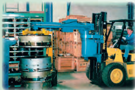
Rameno s hydraulickým výsuvem a otáčením RS20H RS20H jib with hydraulic pushing out and rotation
