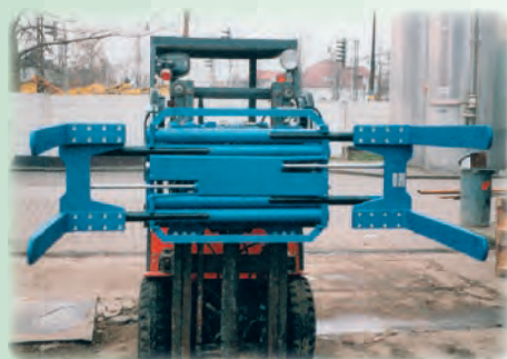
Paletizační zařízení GPA s otáčením 360° Palletizing device GPA with rotation 360°
