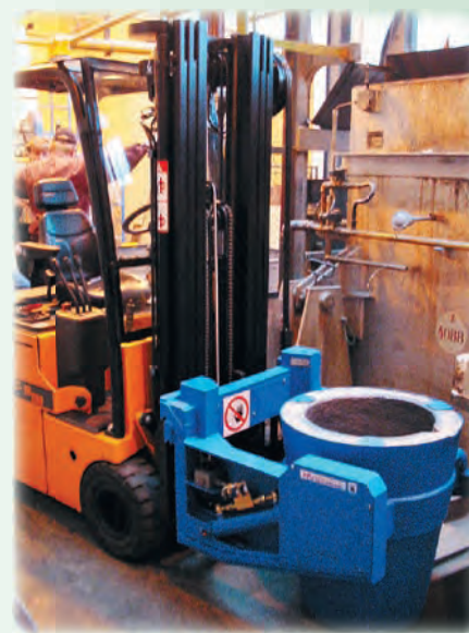
Manipulátor na vylévání tekutého kovu v čelním směru Manipulator for pouring out liquid metal in the frontal direction
