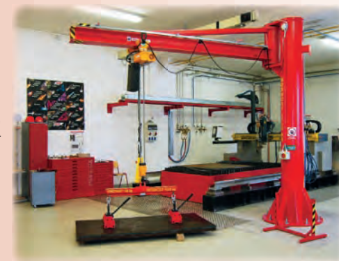
Otočné jeřábové rameno s magnetickou závěsnou konzolou Revolving crane jib with suspended magnetic bracket
