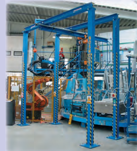
Manipulátor RS10ST pro přemísťování břemen o hmotnosti 1000 kg s příčnou osou pohybu Manipulator RS10ST for moving of load weighing 1000 kg with transversal movement axis
