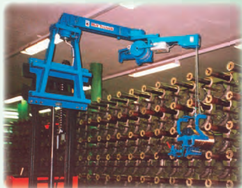
Jeřábové rameno pro zakládání cívek Crane jib for spools loading
