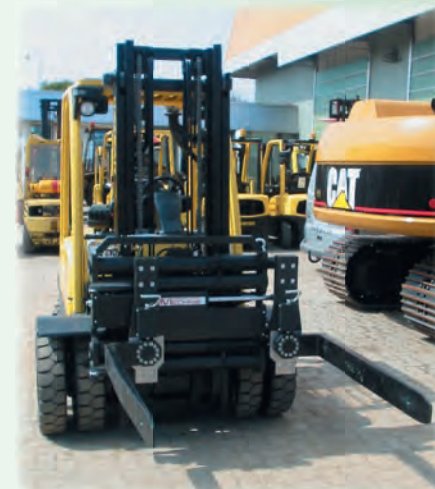
Svěrací vidlice GOV s otočnými nosnými vidlicemi Gripping fork GOV with side rotary supporting forks
